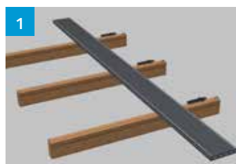
1 Start med at fastgøre start/slut clips i en lige linje i plankernes længderetning, og læg den første række planker.
