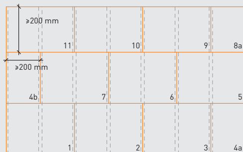
Diagram A1: Anbefalet montage af plader ved 1 lag, liggende.
