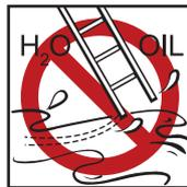
Stellen Sie sicher, dass der Boden frei von Verunreinigungen ist. Leiter darf nicht auf nassem oder rutschigem Untergrund aufgestellt werden.
