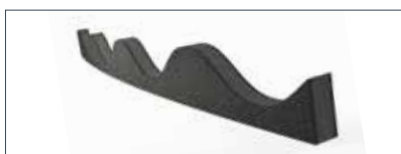
Cembrit Asfaltimpregnerede Skumbølgeklodser Til grat, skotrende og tagryg. Kan an- vendes både under og over bølgeplad- erne (ventilerer ikke tagrum).
