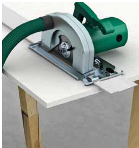
Skæring med dyksav og føringskinne.
