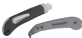
fermacell Ridsekniv eller alm. arbejdskniv anvendes til at ridse pladerne, som efterfølgende knækkes over en kant. Den brudte flade er god til spartelfugesamling, men uegnet til klæbefugesamling.
