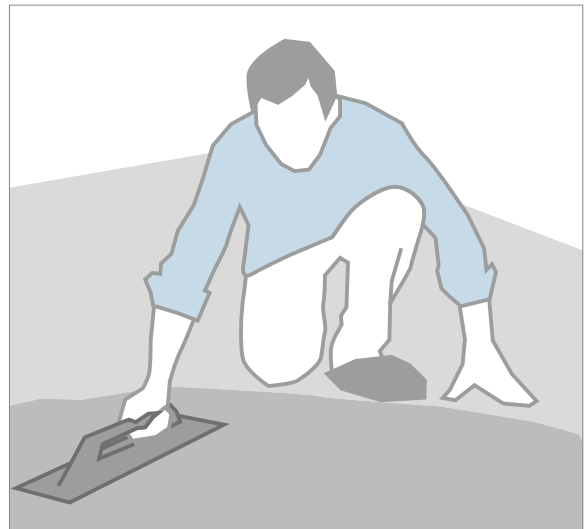
Forbrug: Knauf gulvspartelmasse N 410 ca. 1,6 kg/mm/m 2 - minimum lagtykkelse 2 mm.
