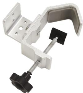
Universal beslag i aluminium som passer til alle HEAT1 terrassevarmere. Let montering af terrassevarmeren på runde eller firkantede rør såsom markisearme, parasolarne eller metalstolper. Fastgør terrassevarmeren til beslaget, hvorefter beslaget nemt og enkelt fastgøres til emnet med én skrue. Indlagt gummimanchet i beslaget beskytter emnet mod skrammer.
