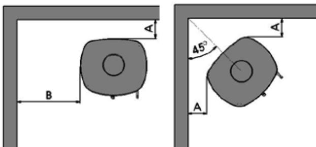
Af hensyn til varmecirkulation, rengøring og evt. indvendig rensning af ovn, anbefales afstand til murværk at være 10-15 cm. Et lag tapet bliver normalt, når det er påsat murværk, betragtet som ikke-brændbart materiale.
