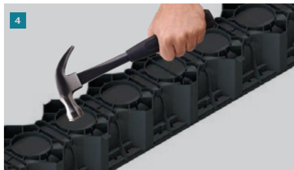
4 Udmål hvilke af udløbsmulighederne i renden der passer bedst til kloaktilslutningen. Slå forsigtig brikken ud. Ved vandret udløb monteres endevæg med vandret udløb. Se produktet på s. 7.
