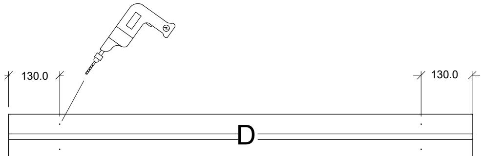
Planker forbores med 3 mm bor max. 20 mm dyb.
