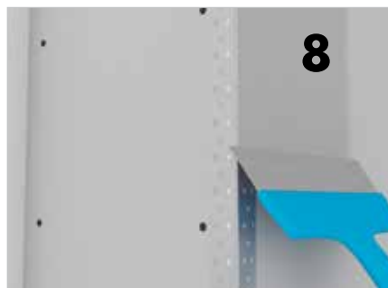
8. Hjørnebeskytter spartles på samme vis som gipspladene. Vi anbefaler minimum 300 mm bred spartling ud fra hjørnebeskytteren. Ønskes samlingerne spartlet til en plan flade anvendes Knauf Uniflott. Forbrug ca. 300 g/m 2 .
