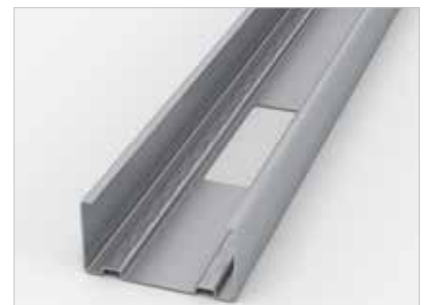
MR stolpe til indervægge. Stolpe med asymmetriske flanger. Kan skydes ind i hinanden. Alle stolper har huller (19 mm bredde) i top og bund for installationsgennemføring.
