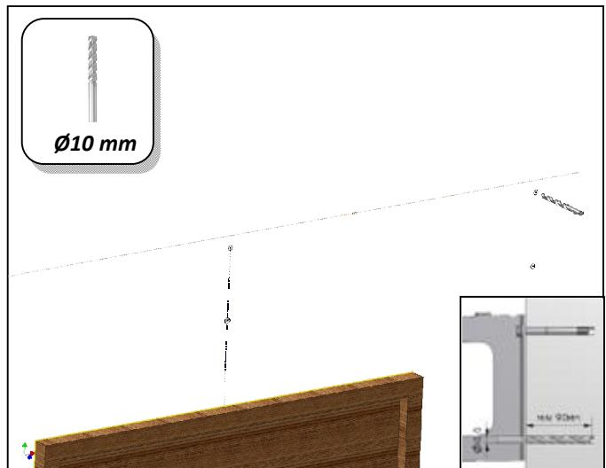
**DK:** Bor hullerne op med et Ø10 mm mur bor, til medfølgende ekspansions bolte (P05). Min. 90 mm. Boltene til fastgørelse kan kun bruges til beton og massive murstens vægge. Hvis udhænget skal hænges op på andet underlag skal anden befæstigelse anskaffes.
