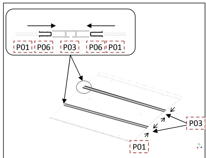
**DK:** Træk beskyttelses filmen af polycarbonat(P01) pladerne på begge sider (Læg IKKE pladen ned uden at beskytte den). Før monteringen af gummilisterne (P06), put listen i varmt sæbevand i ca. 1 min. Dette gør isætningen nemmere. Monter de medfølgende aluminiumslistre (P03).
