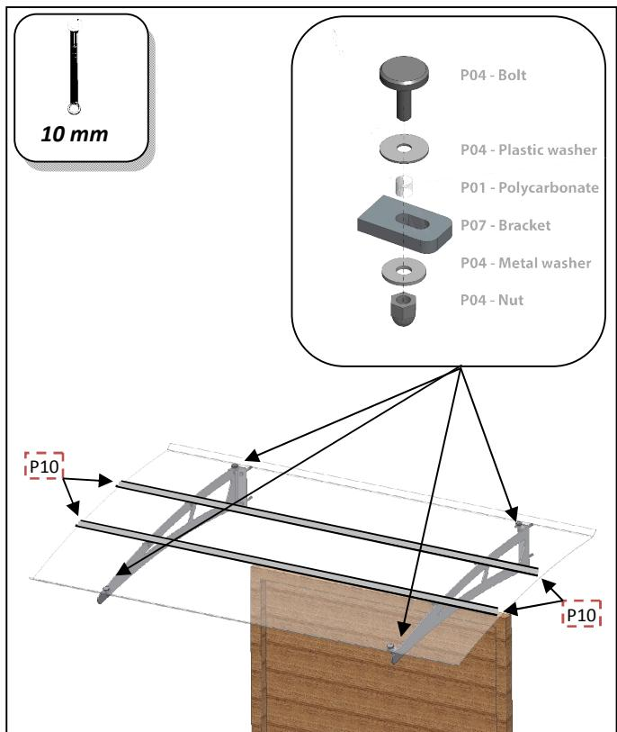
**DK:** Læg polycarbonat pladen op på knægtene og monter den med de medfølgende (P04/P10) møtrikker/bolts. Plastik skiven skal ligge oven på pladen, spænd efter med en 10 mm nøgle. **Fugning:** Ønskes afstanden mellem bagkanten af udhænget og væggen helt tæt, kan denne forsegles med bygnings-silicone.
