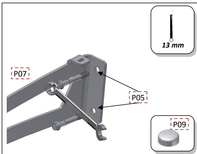
**DK:** Hold knægtene op til de forborede huller og indsæt ekspansionsboltene i hullerne. Spænd ekspansionsboltene, til knægten hænger fast. Boltene spændes med en 13mm nøgle. Påsæt de medfølgende bolthætter(P09).
