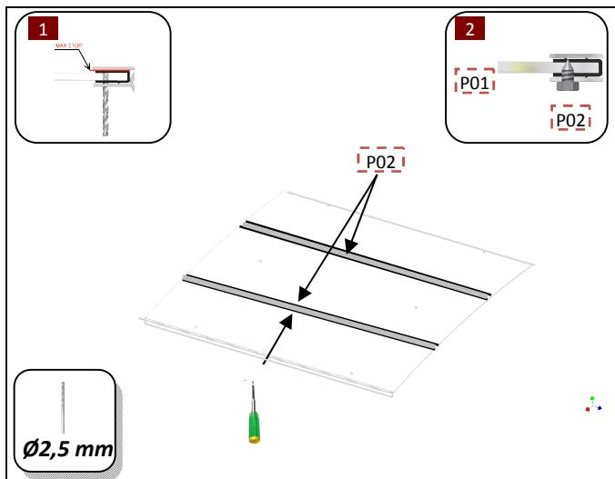
**DK:** Vend polycarbonat pladen om med bagsiden opad. Bor med et Ø2,5mm bør i de forborede huller, MEN kun i gummilisten(P06) og polycarbonat-pladen(P01). IKKE I ALUMINIUMS-LISTEN. Bor KUN 5 mm ned (IKKE HELT IGENNEM). Monter de små medfølgende skruer(P02).
