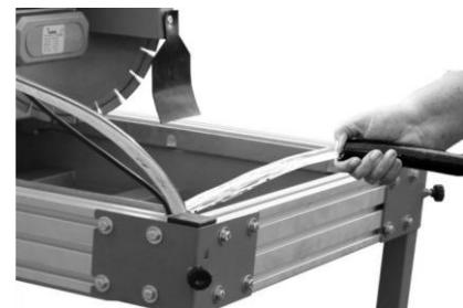
Ved skærearbejde samles meget støv I vandbakken, vandet bør derfor udskiftes ofte for at sikre korrekt operation af pumpen og perfekt køling af skiven. Dertil er bakken udstyret med et dræn.
