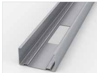
MR stolpe til indervægge. Stolpe med asymmetriske flanger. Kan skydes ind i hinanden. Alle stolper har huller (19 mm bredde) i top og bund for installationsgennemføring.
