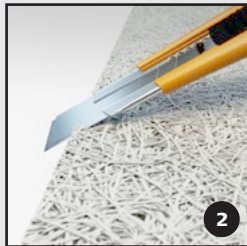
Snit med en hobbykniv et mindre stykke træbeton af den overskydende plade eller vareprøve
