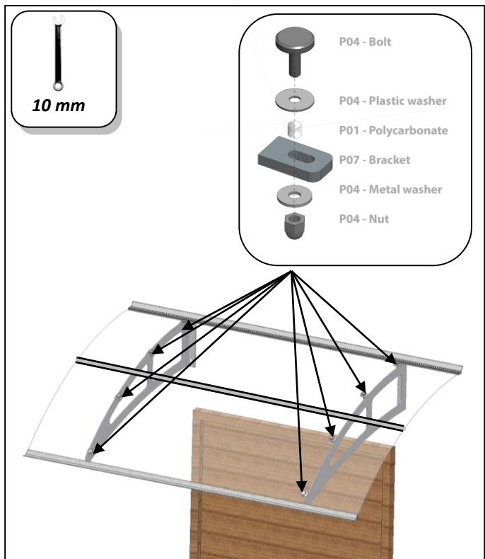
**DK:** Læg polycarbonat pladen op på knægtene og monter den med de medfølgende (P04) møtrikker/bolte. Plastik skiven skal ligge oven på pladen, spænd efter med en 10 mm nøgle. **Fugning:** Ønskes afstanden mellem bagkanten af udhængen og væggen helt tæt, kan denne forsegles med bygnings-silikon.
