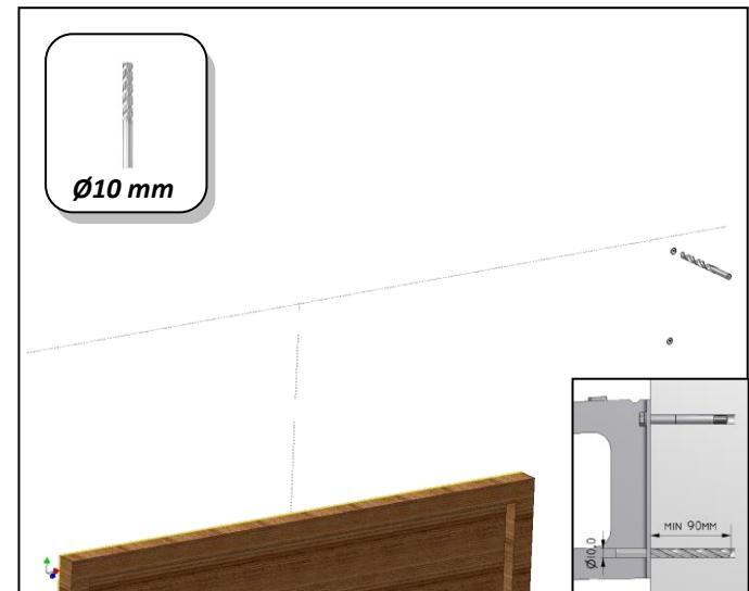
**DK:** Bor hullerne op med et Ø10 mm mur bor, til medfølgende ekspansions bolte (P05). Min. 90 mm. Boltene til fastgørelse kan kun bruges til beton og massive murstens vægge. Hvis udhængen skal hænges op på andet underlag skal anden befæstigelse anskaffes.
