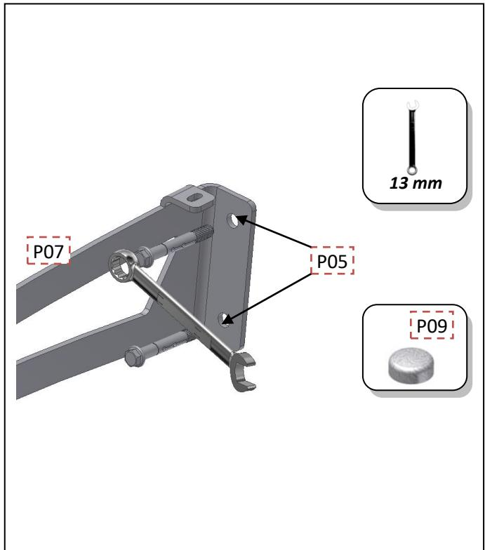
**DK:** Hold knægtene op til de forborede huller og indsæt ekspansionsboltene i hullerne. Spænd ekspansionsboltene, til knægten hænger fast. Boltene spændes med en 13mm nøgle. Påsæt de medfølgende bolthætter(P09).
