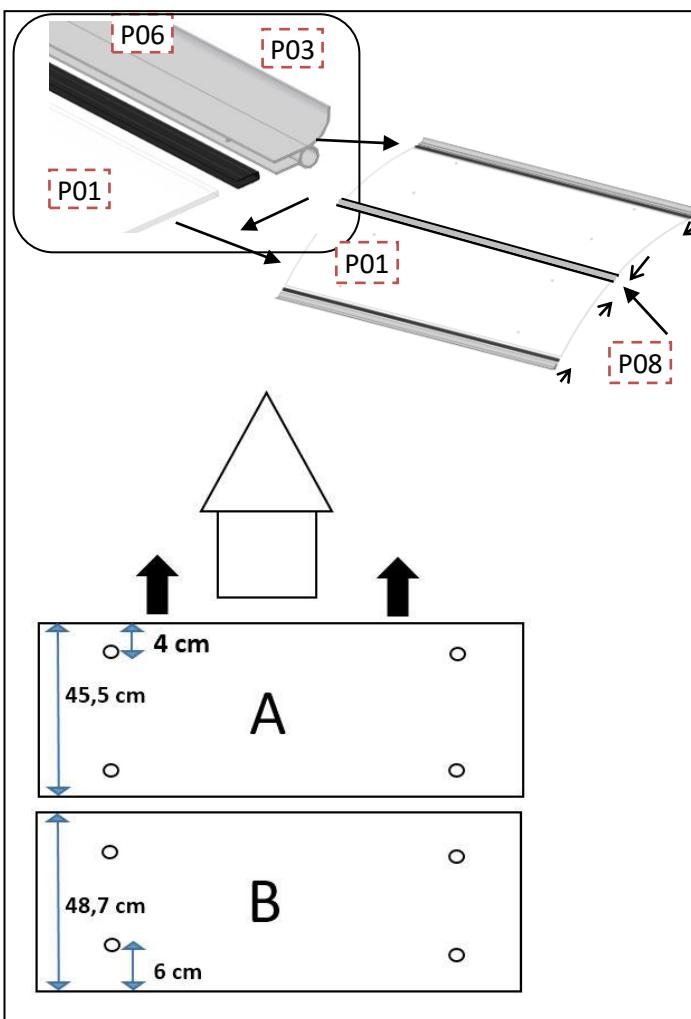
**DK:** Træk beskyttelses filmen af polycarbonat(P01) pladerne på begge sider (Læg IKKE pladen ned uden at beskytte den). Før monteringen af gummilisterne (P06), put listen i varmt sæbevand i ca. 1 min. Dette gør isætningen nemmere. Monter de medfølgende aluminiumslister (P03/P08).
