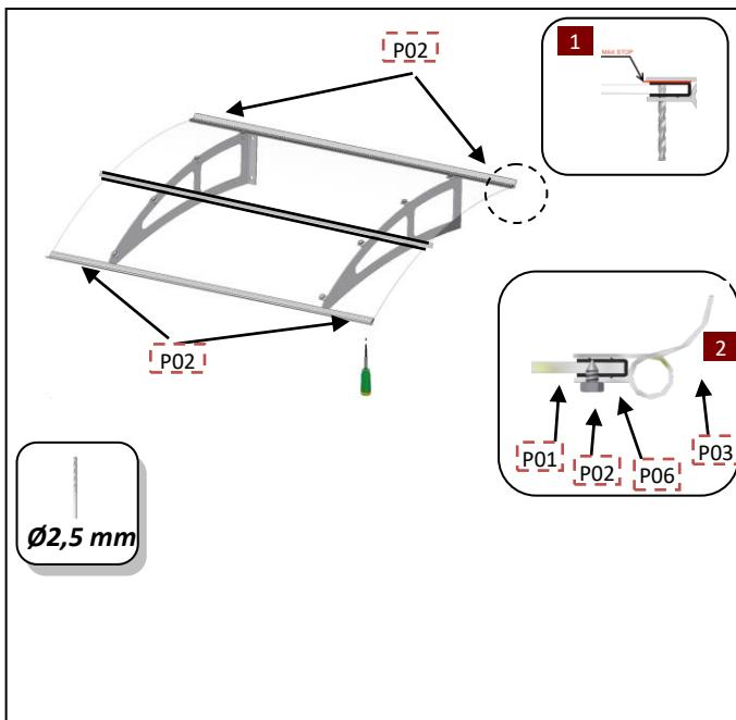
**DK:** Vend polycarbonat pladen om med bagsiden opad. Bor med et Ø2,5mm bør i de forborede huller, MEN kun i gummilisten(P06) og polycarbonat-pladen(P01). IKKE I ALUMINIUMS-LISTEN. Bor KUN 5 mm ned (IKKE HELT IGENNEM). Monter de små medfølgende skruer(P02).
