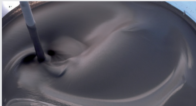
Oprøring af spartelmasse
