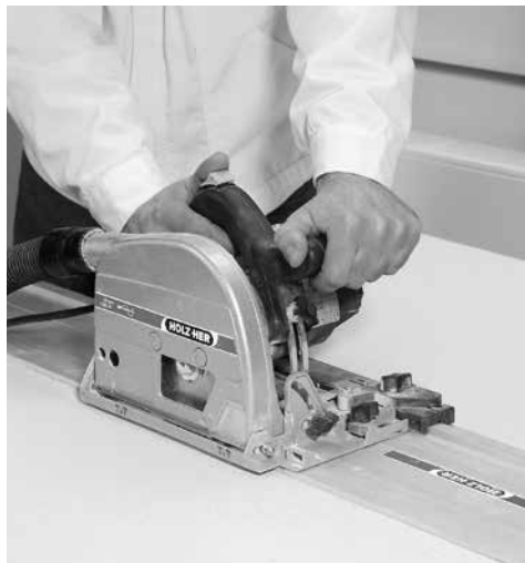
Skæring med dyksav og føringsklinge.
