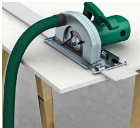
skæring med dyksav, føringskinne og støvsuger.
