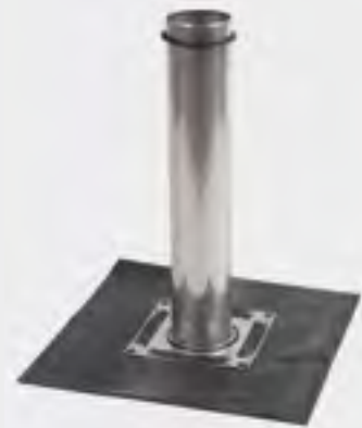
Isola Tagafløb (uden løvrist) Rustfri og syrefast stål med SBS krave 50 x 50 cm. Findes i dim. 50 mm, 62 mm, 75 mm, 90 mm, og 110 mm
