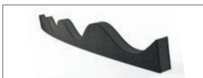
Swisspearl Asfaltimprægnerede Skumbølgeklodser Til grat, skotrende og tagryg. Kan anvendes både under og over bølgepladerne (ventilerer ikke tagrum).
