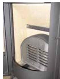
2. Med den ene hånd løftes nederste røgledeplade. Dermed kan man med den anden løfte sidestenen nogle centimeter op. Dette gøres nemmest med en ligekærvet skruetrækker eller lignende. Når stenen er løftet, tipper mellem bunden på plads igen og sidestenen kan dernæst komme fri af mellem bunden og løftes ud
