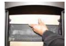
8. Montering af vermiculite dele igen: modsat rækkefølge af udtagning.
