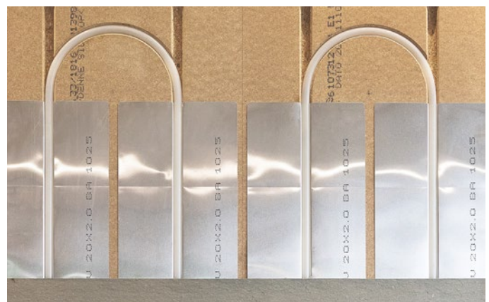
Figur 3 Varmefordelingsplader til 16 mm varmeslanger, sporafstand 200 mm cc.
